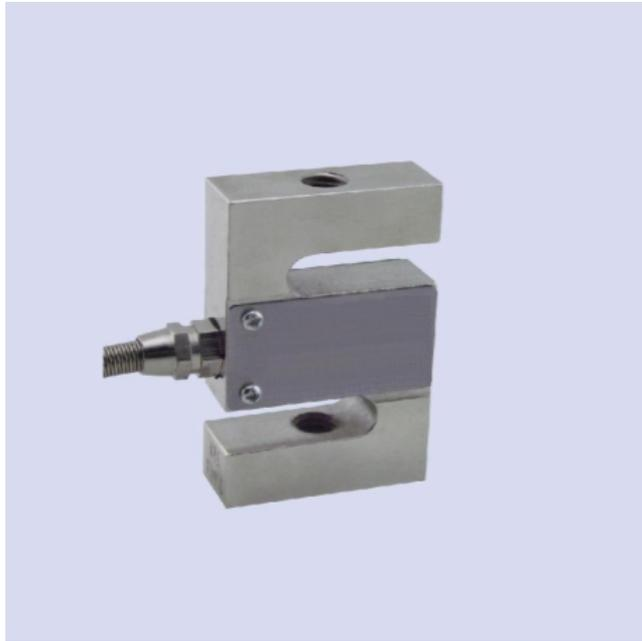
传感器输出信号一般为毫伏信号，分为四线加一根屏蔽线，分别是红黑绿白四根线，黄色为屏蔽线，红色为传感器供电正，黑色为传感器供电负，绿色为信号输出正，白色为信号输出负，由于拉力传感器可测量拉力和压力两种力值，绿色线和白色线可在接线是调换。传感器精度一般为万分之五的精度，传感器灵敏度一般为 $2.000\text{mV/V}$ ，阻抗基本是 $350\Omega$ ，精加工技术精湛，传感器参数固定，材质选质量合金钢，数据稳定，精度高，寿命久。传感器适宜在零下 $20^{\circ}\text{C}$ 至 $60^{\circ}\text{C}$ 范围内工作，如需特殊要求，也可以跟销售沟通，定制高温传感器。贵州配料拉力传感器价格
